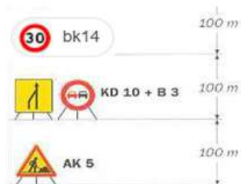
1 Mise en place de la signalisation
