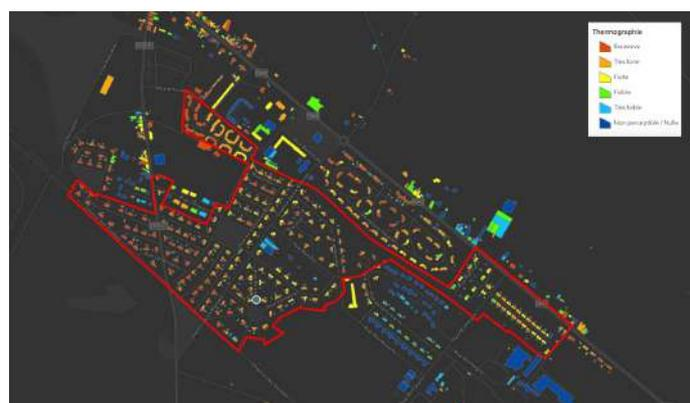
Grâce à l'analyse de cartographies obtenues par thermographie infrarouge aérienne, nous sommes en mesure d'estimer les déperditions thermiques des ensembles immobiliers. Ces données mettent en lumière les déperditions au sein des QPV comptant de nombreux logements avec pertes thermiques importantes.
