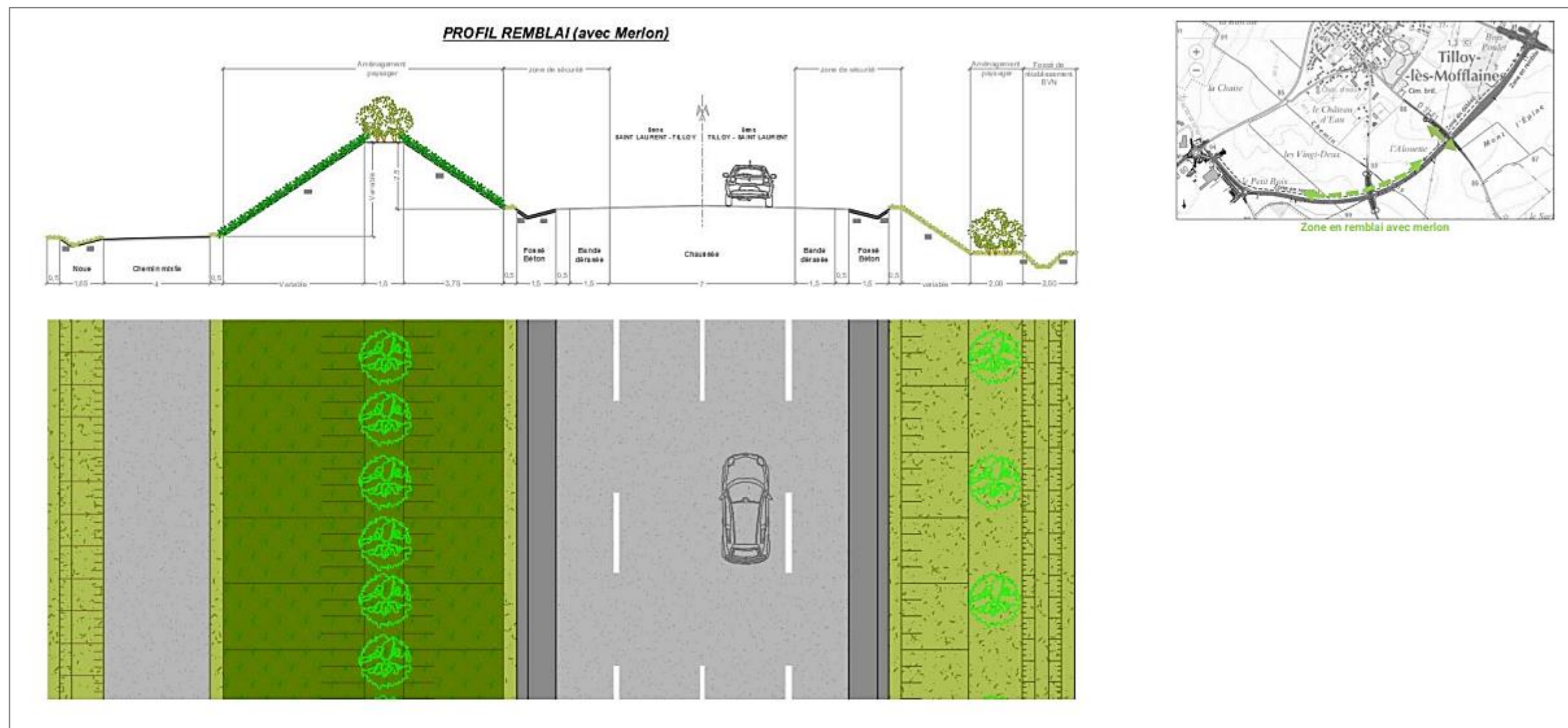
Figure 4 : Profil en travers en remblai de la section courante avec merlon (avec aménagements paysagers)
