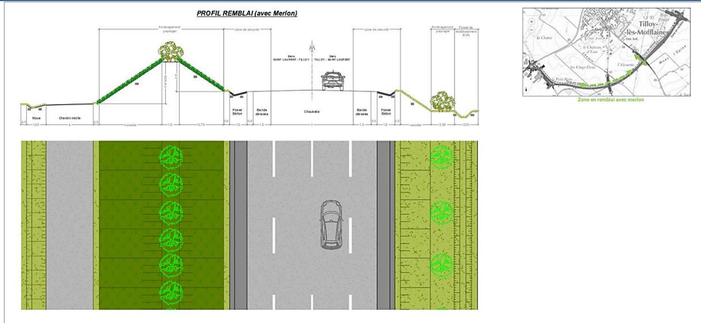
Figure 35 : Profil en travers en remblai de la section courante avec merlon (avec aménagements paysagers)
