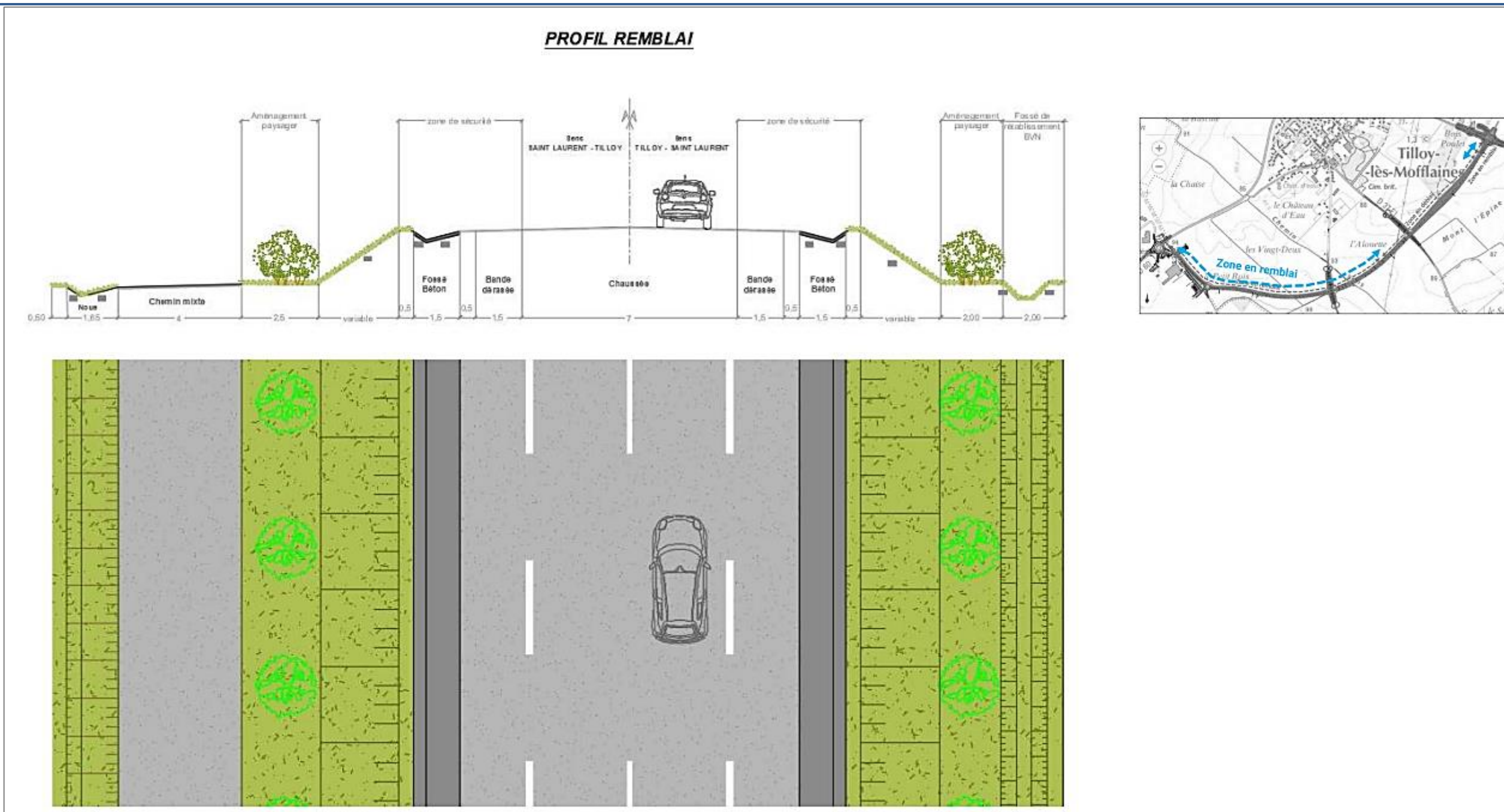
Figure 34 : Profil en travers en remblai de la section courante
