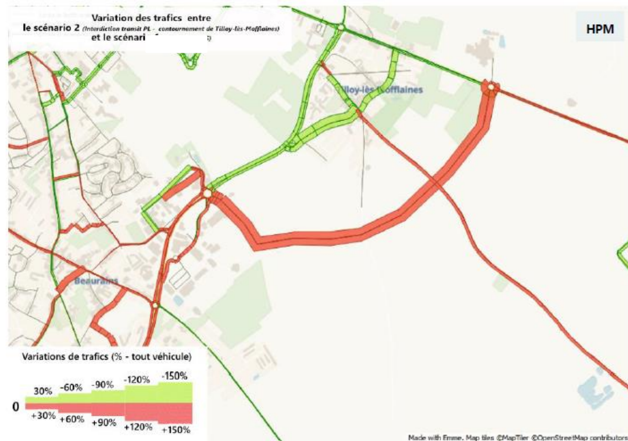
Figure 24 : Variation du trafic suite à la mise en service du contournement de Tilloy-lès-Mofflaines
