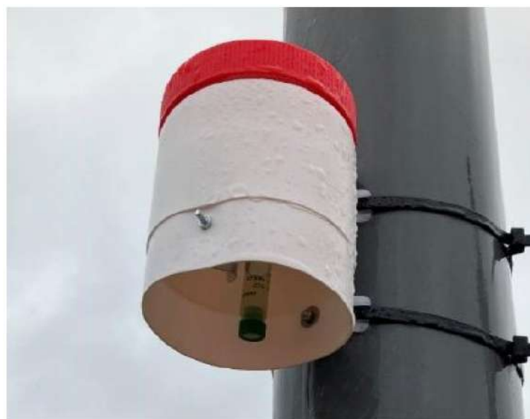
Figure 8 : Boîte de protection possédant un tube de mesure de \text{NO}_2
