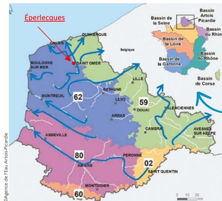
Figure 12 : Schéma sur le fonctionnement hydraulique de la cuvette audomaroise
