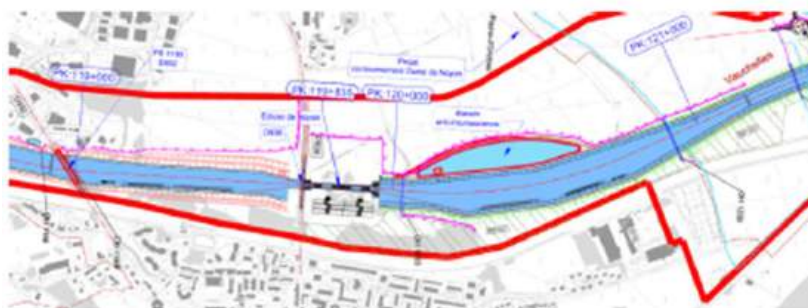
Exemple de bassin anti-intumescence sur l'écluse de Noyon (source : ONE 2021)
