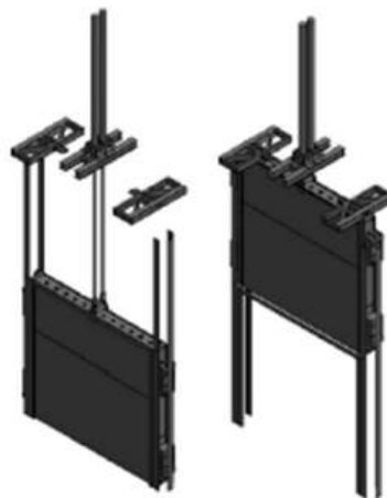
Système portes aval des écluses
