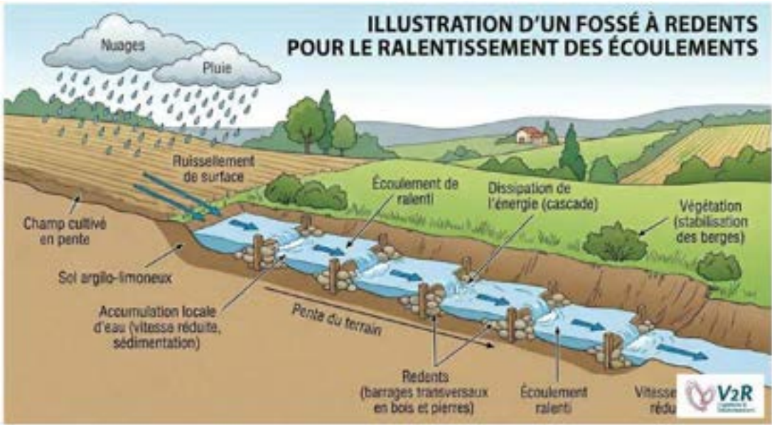
Schéma de principe illustrant l'intérêt d'un fossé à redents:
